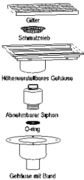
Dezentraler Abfluss mit höhenverstellbarem Gehäuse
